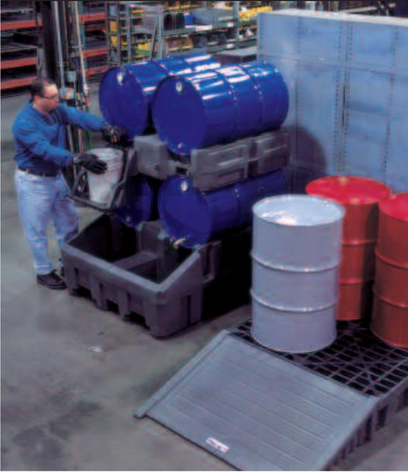
*Los módulos combinan el almacenamiento eficiente de los tambores con el control positivo de los derrames.*
